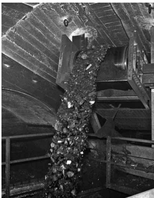
La fotografia permet observar el detall de com descarrega la cinta al pou del nivell Consolació del "tot-u" (nom que es dona al carbó barrejat amb la pedra) i que posteriorment serà destriat al rentador de carbó situat a l'exterior de la mina. (ARXIU COMARCAL DEL BERGUEDA, FONTS JOSEP DESEURAS, 04013050004245, 004)
